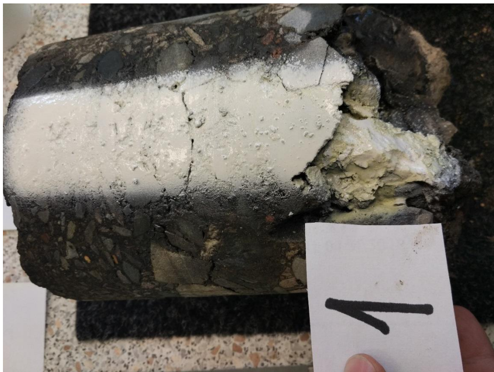
Obr. 27 Detail přítomnosti PAU na AC vývrtnu JV1
