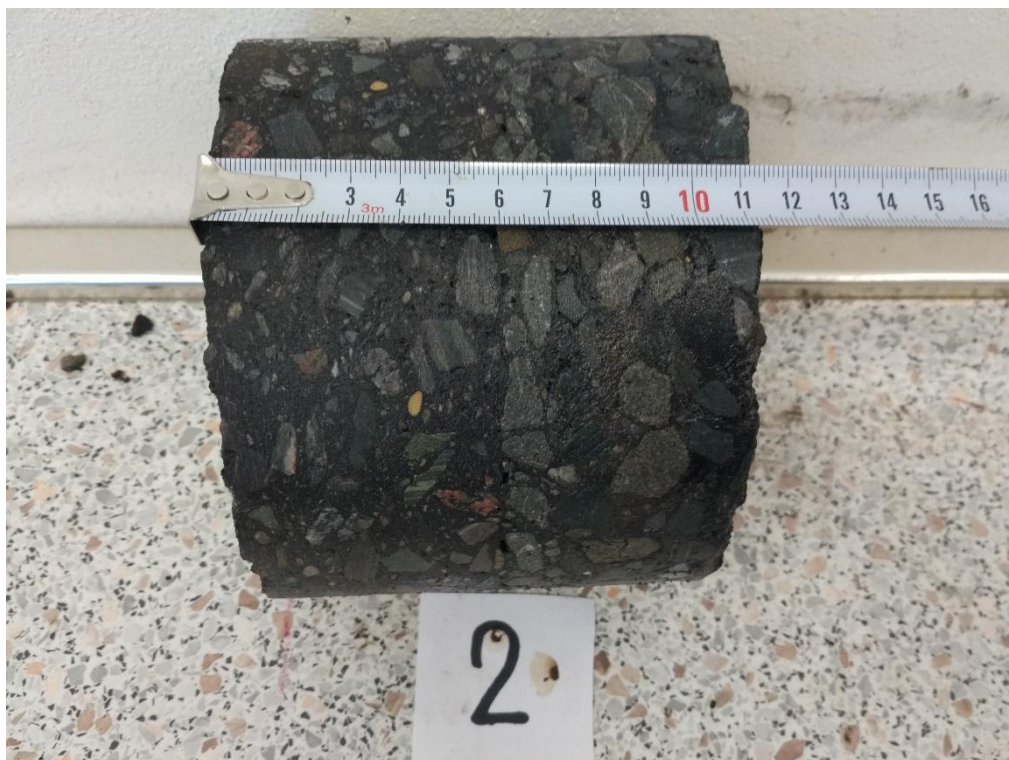
Obr. 26 AC vývrt JV8, most 644-003 Pěčíkov - Hraničky
