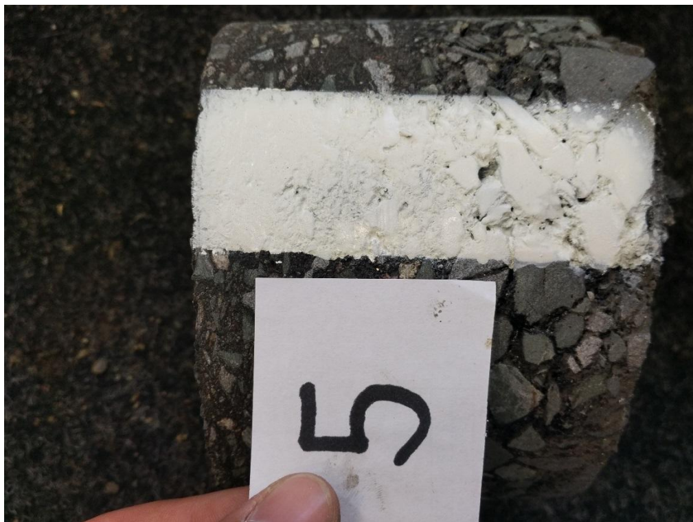
Obr. 31 Detail negativní přítomnosti PAU na AC vývrtnu JV5
